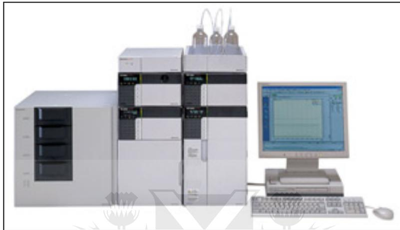
Cromatógrafo líquido de alta performance Shimadzu
