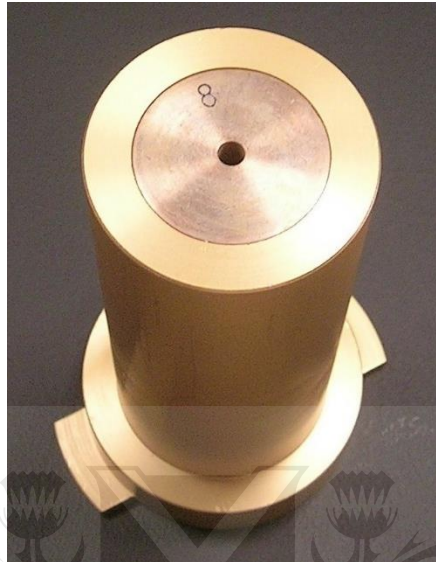
Figura 3: Colimador para Radiocirugía (de 8 mm de diámetro).
