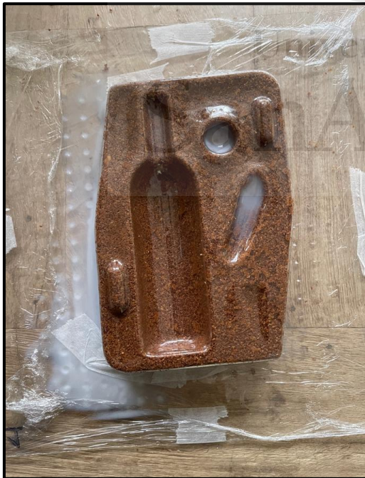
Molde termoformado para packaging de vino a microescala recién moldeado y prueba de pieza de packaging de cosmética finalizada
