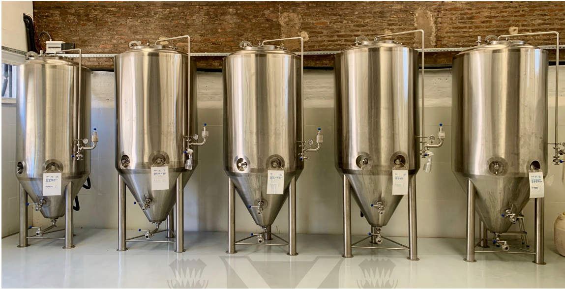
Foto 1. Fermentadores cilindro-cónicos de acero inoxidable
