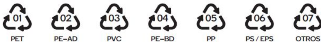
Figura 5. Clasificación y símbolos de los principales polímeros plásticos.
