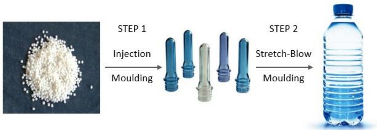
Imagen 3 – Etapas de la obtención de una botella PET (CyPet, 2018).
