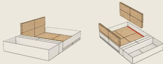
3. Colocar la pieza a sobre el sector donde se colocó el adhesivo en el paso 2. Mantener con presión y dejar secar unos segundos.
