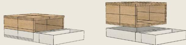
7. Colocar la pieza b sobre el sector donde se colocó el adhesivo en el paso 6. Mantener con presión y dejar secar unos segundos, luego remover el stand del taco de soporte con cuidado.
