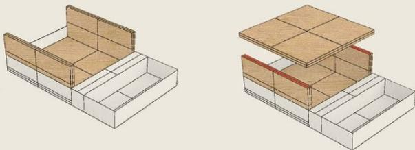
5. Colocar la pieza a sobre el sector donde se colocó el adhesivo en el paso 4. Mantener con presión y dejar secar unos segundos.
