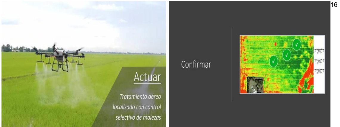
Imagen 14 y 15: La fase de acción ejecuta el tratamiento localizado y selectivo y finalmente confirma las malezas eliminadas.
