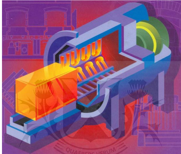
Figura 1.1.- Horno de resistencias.
