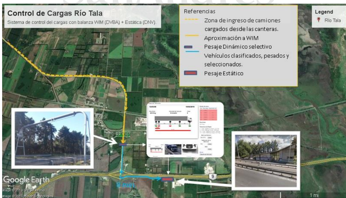
Fig. 11 - Diagrama de pruebas WIM (DPV) + Balanza estática (DNV)
