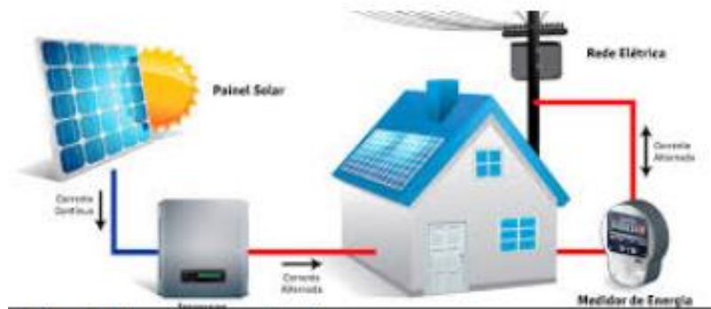
Figura número 10: funcionamiento de un sistema fotovoltaico residencial.
