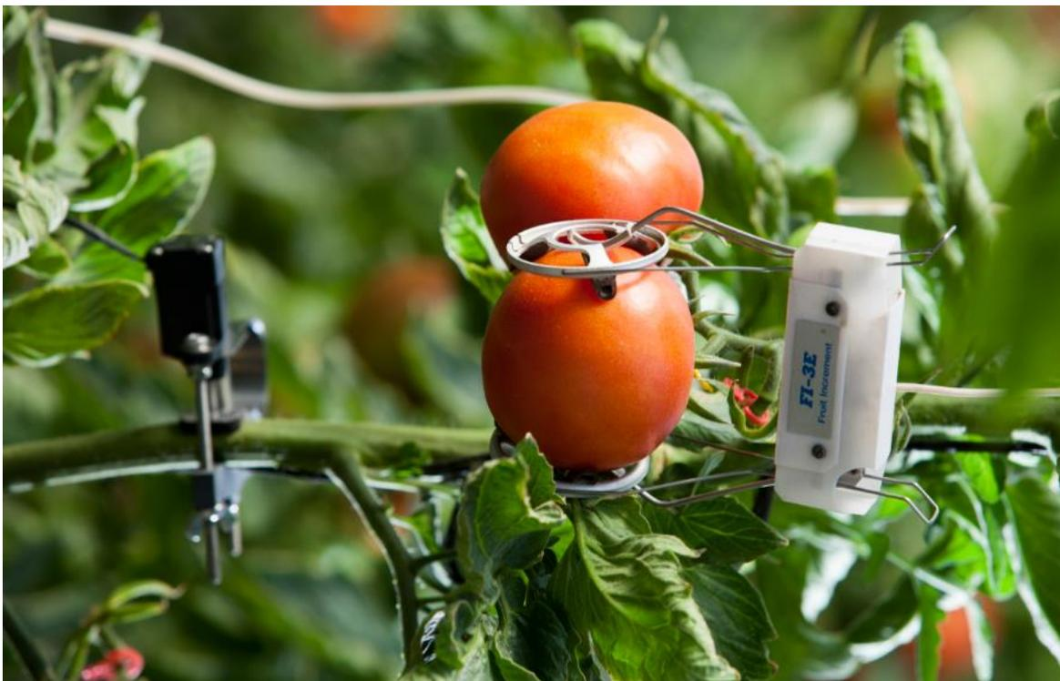
Ilustración 24 - Sensores de diámetro de tallo y fruta<sup>28</sup>
