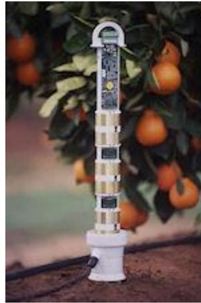
Ilustración 23 - Medidor de la constante dieléctrica "EnviroSCAN"<sup>26</sup>
