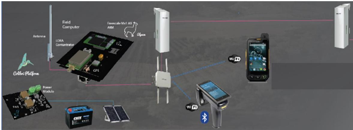
Ilustración 25 - Diagrama de conectividad<sup>29</sup>
