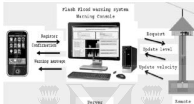
Figura 49. Sistema de alarma de inundación via SMS. Filipinas.
