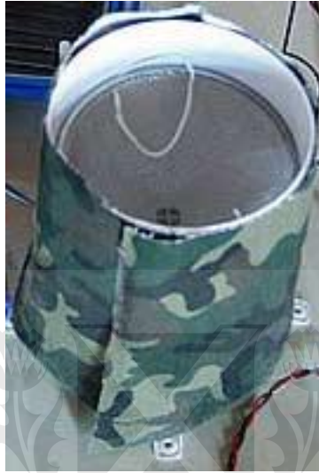
Figura 22. Sensor de lluvia camuflado.
