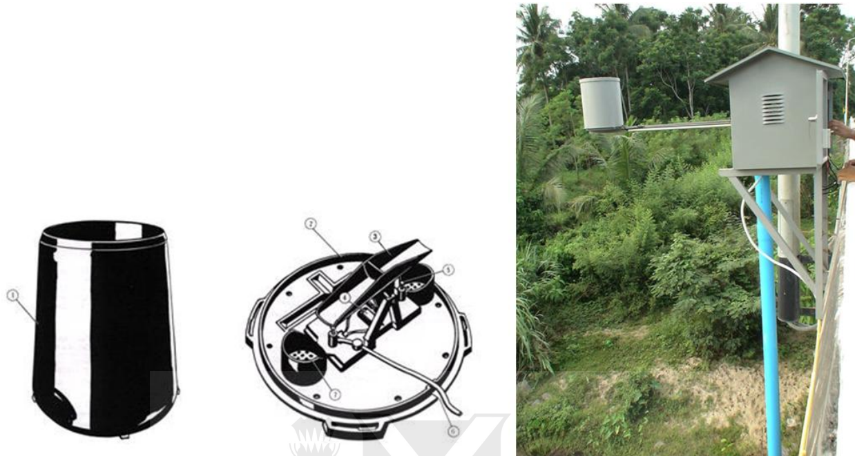
Figura 24. Sensor de precipitación y su vista instalado.
