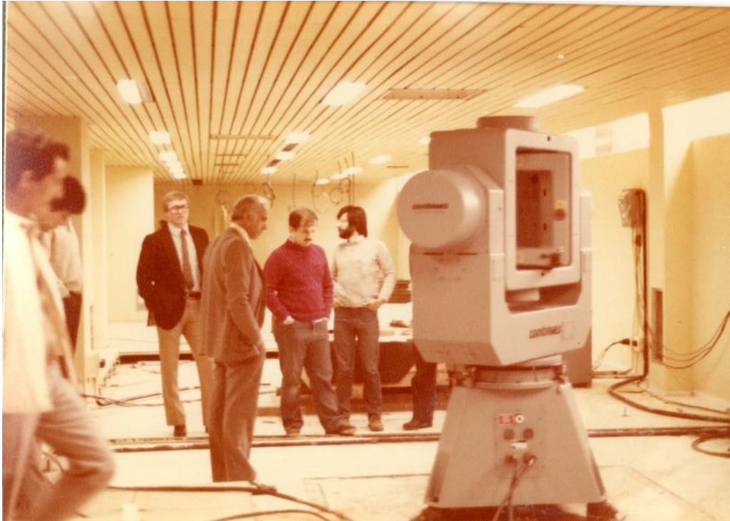
Mesa de ensayos multi-axis CONTRAVES de fabricación europea, utilizada para prueba de sistemas de guiado inercial para el Cóndor II. Los mismos se encontraban en el Centro Espacial San Miguel de la CNIE, en las afueras de Buenos Aires. Fuente protegida.
