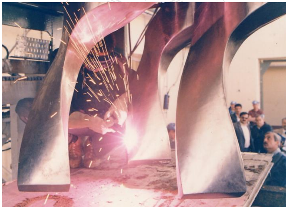
Personal de las Naciones Unidas controla la destrucción de las paletas de una mezcladora de propulsante de 1.200 litros en la Planta Rashid similar a la existente en Falda del Carmen. Cortesía UNMOVIC.
