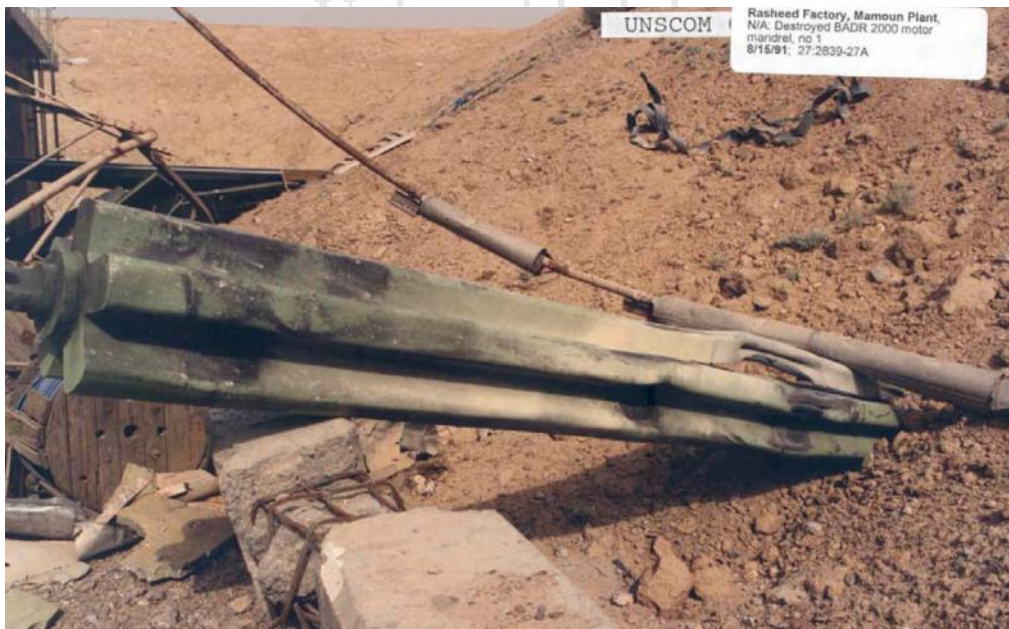
Mandriles teflonados del BADR-2000 para la formación de la estrella dentro del motor cohete. Estas piezas, provistas por CONSEN, eran iguales a las utilizadas para el motor del Cóndor. Cortesía UNSCOM.
