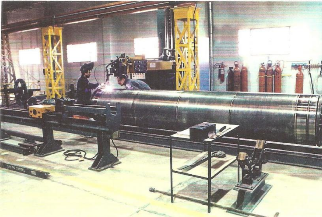
Vista de la planta Dos-Tec S.A. durante el soldado de tubos motor para el Cóndor en 1988. Cortesía: Ing. Raúl Pardo.
