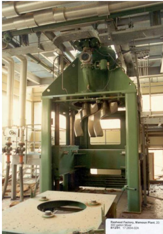
Mezcladora de propulsante de 1.200 litros encontrada en la factoría Rasheed en Irak. Equipos muy similares eran utilizados en Falda del Carmen. Cortesía UNMOVIC.
