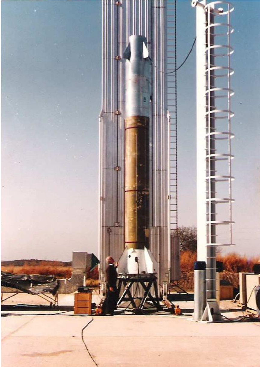
Mockup parcial del Cóndor II en posición de lanzamiento, con la torre retirada y sus puertas cerradas.
