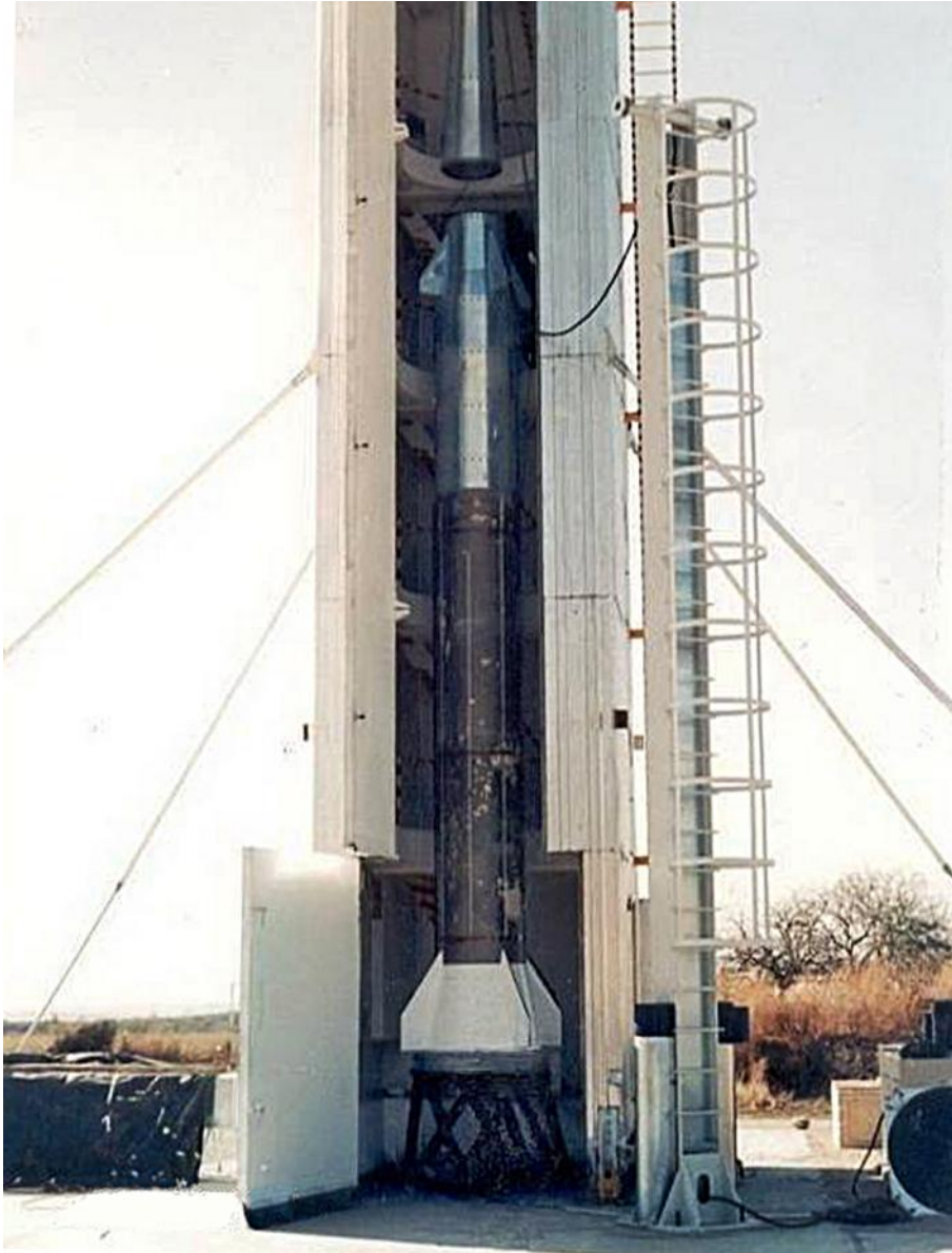
Otra vista de la torre de servicio vertical con las puertas abiertas. Adentro se aprecia un mockup del Cóndor II con un motor ya utilizado en pruebas de banco.
