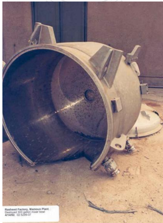
Recipiente para la mezcladora de propulsante inutilizado por Naciones Unidas. Planta Rashid, Irak. Cortesía UNMOVIC.
