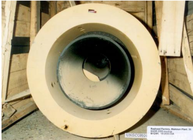
A la izquierda se observa la vista de la tobera de un mockup del BADR-2000 encontrada en Rashid, Irak. A la derecha se aprecia una vista lateral del conjunto "tailcan" y tobera de un mockup del Cóndor II fabricada en Aeropac/Aerotec en Mendoza. Cortesía UNMOVIC y Dr. Gustavo Marón.
