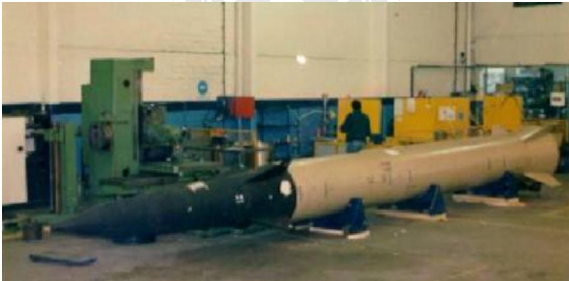
Otra vista de un mockup dimensional del misil Cóndor II fabricado en Mendoza por Aerotec/Aeropac. Cortesía Dr. Gustavo Marón.
