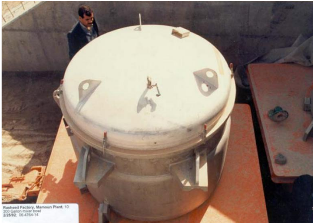
Recipiente para la mezcladora de propulsante de 1.200 litros. Planta Rashid, Irak. Cortesía UNSCOM.
