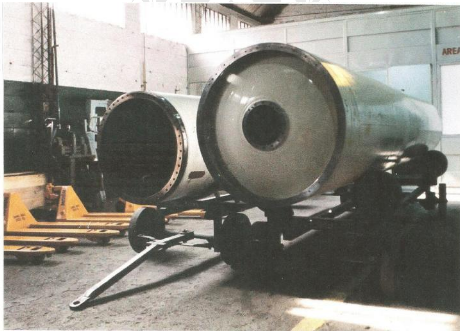
Vista de la planta Dos-Tec S.A. durante el armado final de tubos motores, los cuales eran llevados a Falda del Carmen para su llenado con el combustible sólido.
