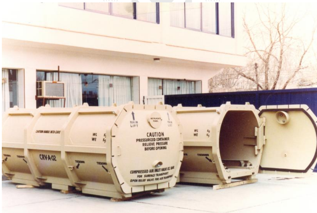
Contenedores para albergar motores cohete Cóndor II cargados de combustible. Estos contenedores presurizados fueron fabricados en Mendoza por Aeropac/Aerotec. Nótese las inscripciones en inglés de precaución. CRV-A02 significa “Cóndor Research Vehicle A02” Los motores del Cóndor que fueron exportados a Egipto se cargaban de a dos en un contenedor cada uno, a bordo de un avión Hércules de la Fuerza Aérea. Cortesía Dr. Gustavo Marón.
