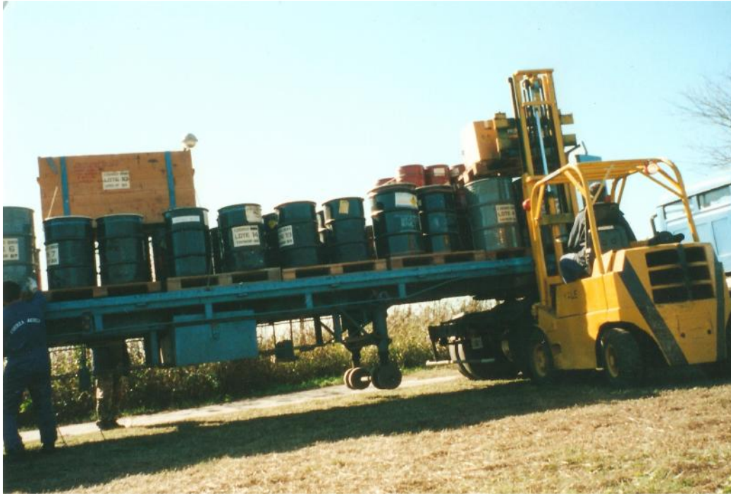
Descarga de un camión con tambores de Perclorato de Amonio, el oxidante para el propulsante del Cóndor. El mismo era importado, ya que en el contrato con CONSEN no se incluyó una planta para la fabricación del mismo.
