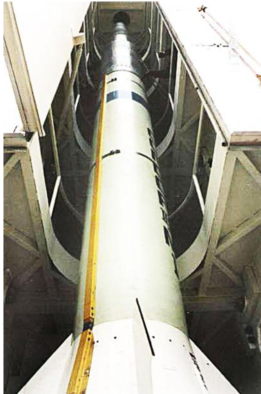
Vista desde abajo hacia arriba de un misil Cóndor II dentro de la torre de servicio vertical. Esta configuración se probó en Falda del Carmen, para completar la logística para el lanzamiento abortado en Cabo Raso.
