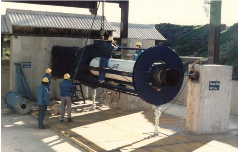
Colocación de un motor del Cóndor en el banco de ensayos estáticos de Falda del Carmen. Archivo del autor.
