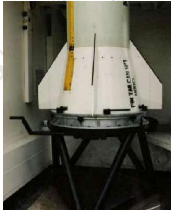
Conjunto de cola del Cóndor II (Tailcan) y TVC. El misil reposa sobre el "banquito" o stool. Archivo del autor.
