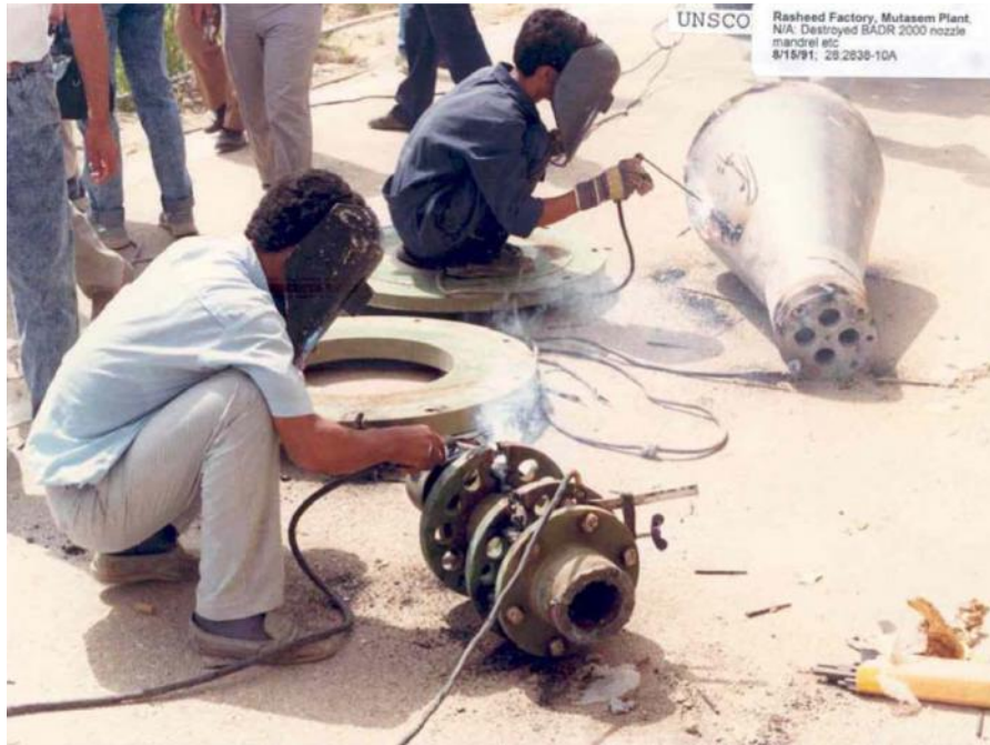
Personal contratado por las Naciones Unidas destruye elementos utilizados para la construcción de la tobera del motor cohete del BADR-2000 en Irak. Cortesía UNMOVIC.
