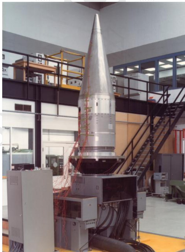
Primera ojiva del Cóndor I. Además de sistema de separación e instrumentación la misma poseía un paracaídas para facilitar su recuperación. Cortesía Brig. Sthal.
