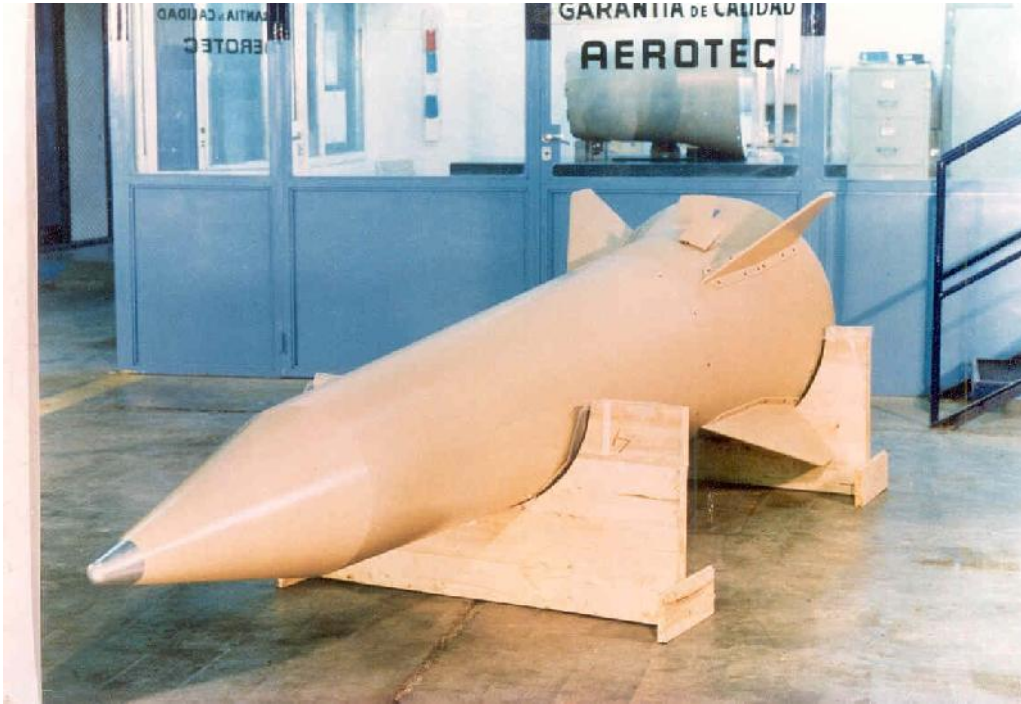
Mockup de la ojiva de reentrada fabricada por Aerotec/Aeropac. Cortesía Dr. Gustavo Marón.
