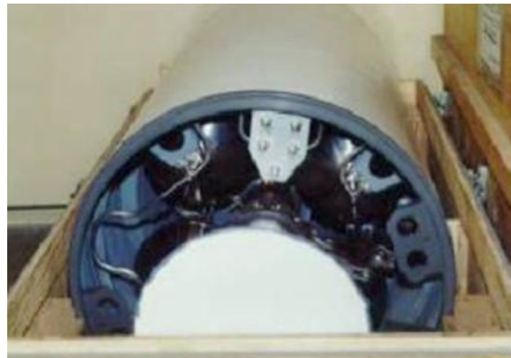
Fotografía del motor líquido hipergólico de la segunda etapa del Cóndor II. Archivo del autor.
